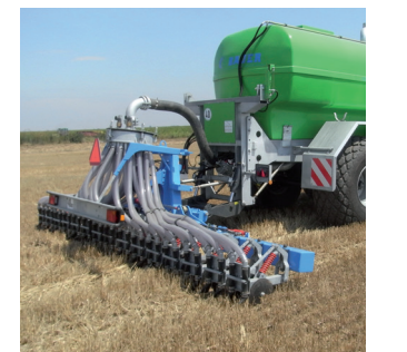
Vágókéses hígtrágyakijuttatók Innovatív megoldások
